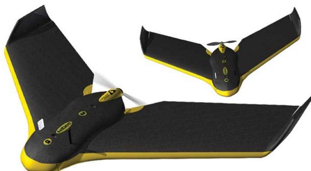
Figura 2 - Avião não-tripulado de asa fixa
