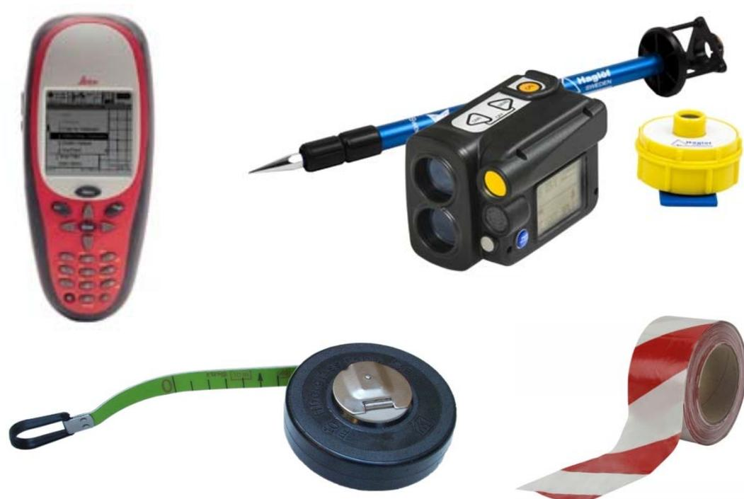
*Da direita para a esquerda, e de cima para baixo, temos: 1) sensor cor normal, 2) sensor de infravermelho, GPS GS20, hipsómetro Vertex III e transponder para medição de alturas, fita métrica e fita para marcação de árvores.*
